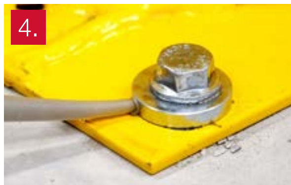
4. Fyll gapet mellan betongskruven och fixturen genom hålet i fyllnadsbrickan tills injekteringsmassa läcker ut ur detta hål. Observera installationsanvisningarna för injektionsmassan. Belastning får ske när massan har härdat
