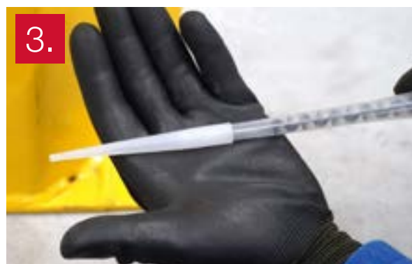
3. Sätt fast blandarens reduceringsspets på blandarmunstycket. Vid behov kan tejp användas.
